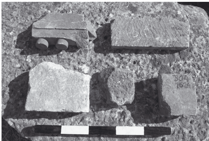
Abb. 93: Vierungseinsätze und Flickstücke für Werksteinreparaturen
